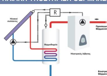
Διατήρηση σταθερής θερμοκρασίας προσαγωγής σε συστήματα ηλιακής υποστήριξης θέρμανσης, σε ώρες που δεν επαρκεί η ηλιακή ενέργεια.
